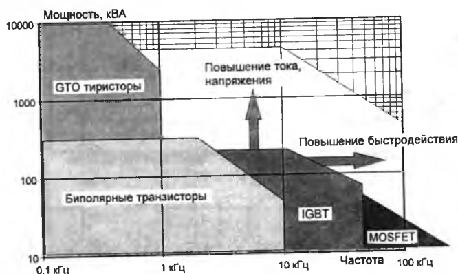
Рис.1. Области применения силовых полупроводниковых приборов и направления развития IGBT транзисторов
