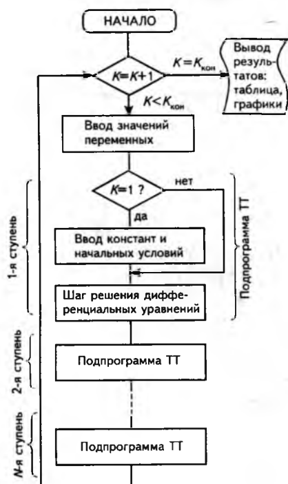
Рис.4. Алгоритм программы цифровой динамической модели каскадного трансформатора тока
