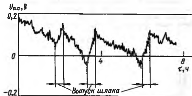
Рис. 1. Изменение U_{п.с.} фазного напряжения на печи ОКБ-767 (10,5 МВА) для получения фосфора
