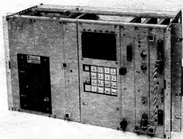
Рис. 1. Микропроцессорный измеритель-регулятор скорости
