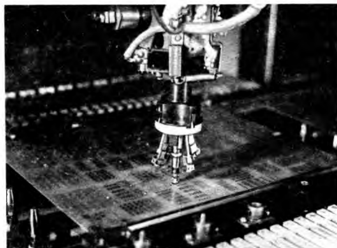
Рис. 3. Демонстрация установки элемента на печатную плату
