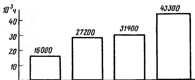
Рис. 4. Средняя наработка на отказ четырех различных типов СГЭ
