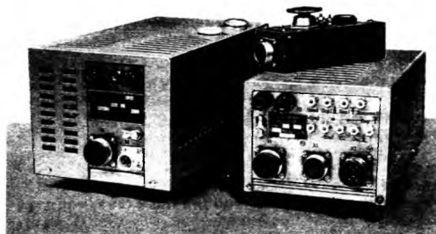
Рис. 2. Электроприводы управления манипуляторами МСЭ-160 типа ЭП МСЭ-160
