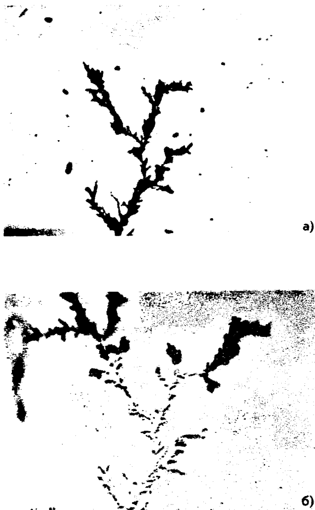
Рис. 8. Стадии роста электрического триннга, выращенного с применением установки рис. 2. Видеомикрофотографии: а — сравнительно ранняя стадия; б — арифметическая разность изображений двух стадий роста, характеризующая приращение структуры триннга
