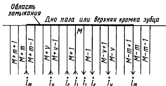
Рис. 2. Схема индуцированных токов в замкнутых контурах пакета
