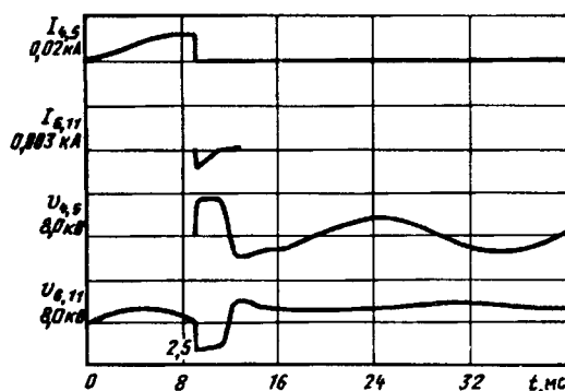
Рис. 4. Расчетные осциллограммы отключения тока холостого хода печного трансформатора при его защите с помощью ОПН
