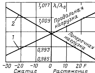
Рис. 2. Зависимость нормированной глубины проникновения магнитного поля в металл от величины механического напряжения: 1 — \bar{F} = \{F_x, 0, 0\} ; 2 — \bar{F} = \{0, 0, F_z\}
