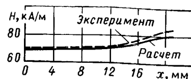
Рис. 6. Результаты расчета и экспериментального исследования продольного поля на оси системы
