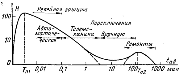
Рис. 1. Зависимость частоты аварийных простоев от длительности аварии для системы электроснабжения нефтеперерабатывающего цеха химического комбината в ГДР.
