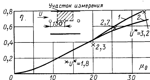
Рис. 4. Зависимость степени очистки от параметра \mu_0 . \bar{u}=1 м/с; U_0=11 кВ; D_0=2 \cdot 10^{-3} м 2 /с. 1 — расчет по (5); 2 — расчет по формуле Дейча (2); × — эксперимент.
