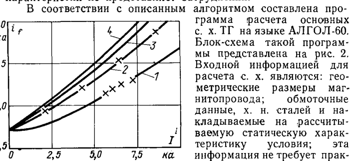
Рис. 3. Расчетные регуляторные характеристики турбогенератора ТГВ-200 при u = u_n . 1, 2, 3 и 4 — соответствуют коэффициентам мощности 1; 0,8; 0,6; 0. ххх — экспериментальные точки.
