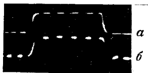
Рис. 4. Осциллограммы прямоугольного импульса на ячейке Поккельса (а) и на выходе ФЭУ (б) опто-электронного трансформатора напряжения. Метки времени — через 1 мксек.
