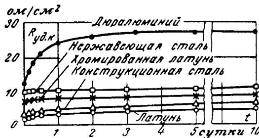
Рис. 2. Влияние степени окисления электродов на удельное контактное сопротивление для резины на основе СКН-3.
