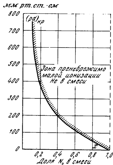
Рис. 5. Зависимость критического значения (pd)_{кр} от концентрации азота в смеси гелия с азотом.
