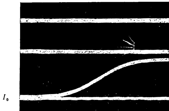
Рис. 3. Переходный процесс в обмотке управления при отключенной трехфазной обмотке.
