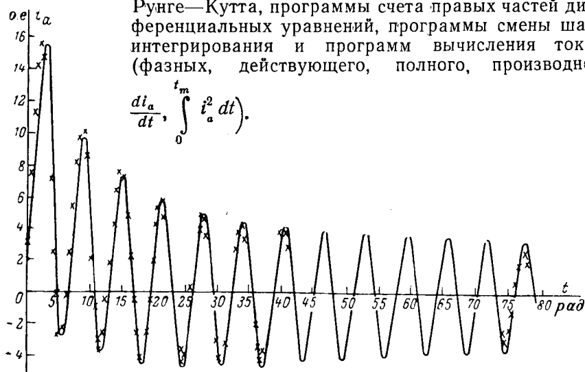
Рис. 7. Ток короткого замыкания на зажимах модельного генератора U_1=2,5 ; \gamma_0=145^\circ .
