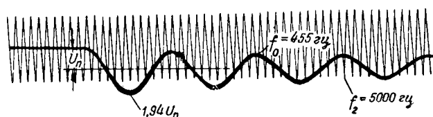
Рис. 5. Катодная осциллограмма волны коммутационного перенапряжения, прикладываемого к выключателю МГ-110 при проверке его изоляции после многократных отключений токов короткого замыкания.
