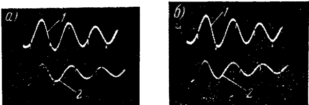
Рис. 15. Осциллограммы первичного и вторичного токов трансформатора тока типа ТПНШ-2 при f = 28 кГц.
