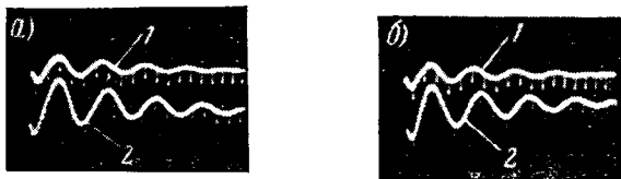
Рис. 14 Осциллограммы первичного и вторичного токов трансформатора тока типа ТПНШ-2 при f = 13,5 кГц.
