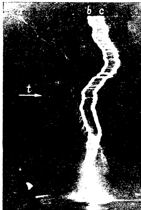
Рис. 5. Фоторазвертка разряда с искусственно созданной ступенью в лидере. a — начало развития лидера; b — ступень; c — главный разряд. Воздушный промежуток стержень — плоскость; H = 200 см; R_m = 400\,000 ом.
