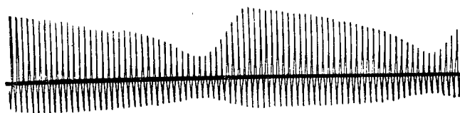
Рис. 8. Осциллограмма колебаний в схеме по рис. 2, напряжение сети U = 50 в.
