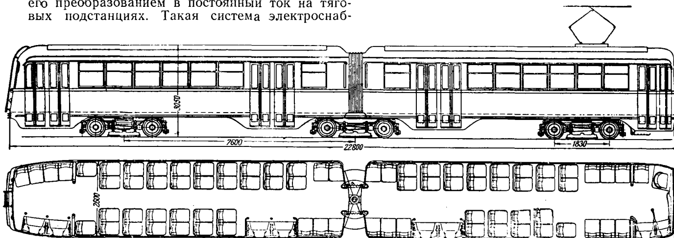
Рис. 5. Проект шестиосного трамвайного вагона сочлененного типа серии Академии коммунального хозяйства.
