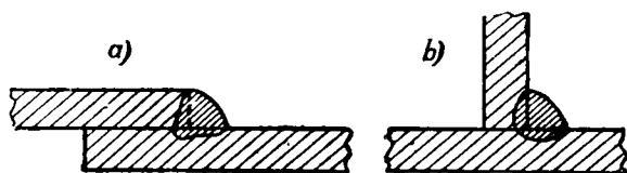
Рис. 5. Употребительные формы соединений для подводной сварки.
