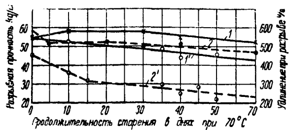
Рис. 1. 1 и 2 — разрывная прочность и удлинение теплостой- кой резины; 1' и 2' — то же нормальной резины
