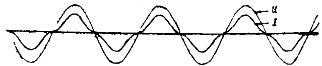
Рис. 7. Осциллограмма тока тирита при синусоидальном напряжении
