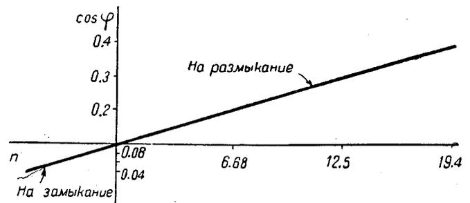
Рис. 1. Зависимость числа оборотов ваттметрового прибора от  $\cos \varphi$
