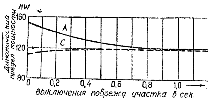
Рис. 8. Влияние длины линии передачи на эффект быстродействующего выключения
