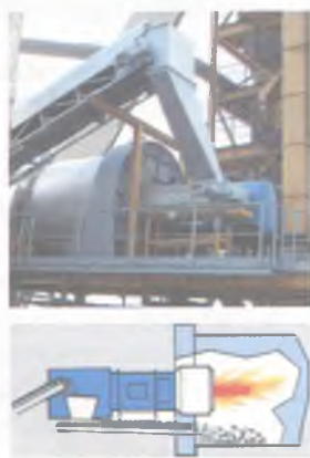
Рис. 1. Система добавки фрезежа в холодном виде в сушильный барабан
