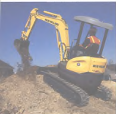
New Holland E30SR — экскаваторы могут выпускаться и без застекленной кабины
