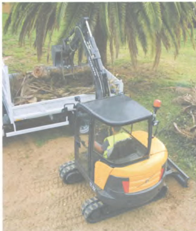
Модель Volvo EC35C может работать со специальным захватом для объемных предметов, например, бревен
