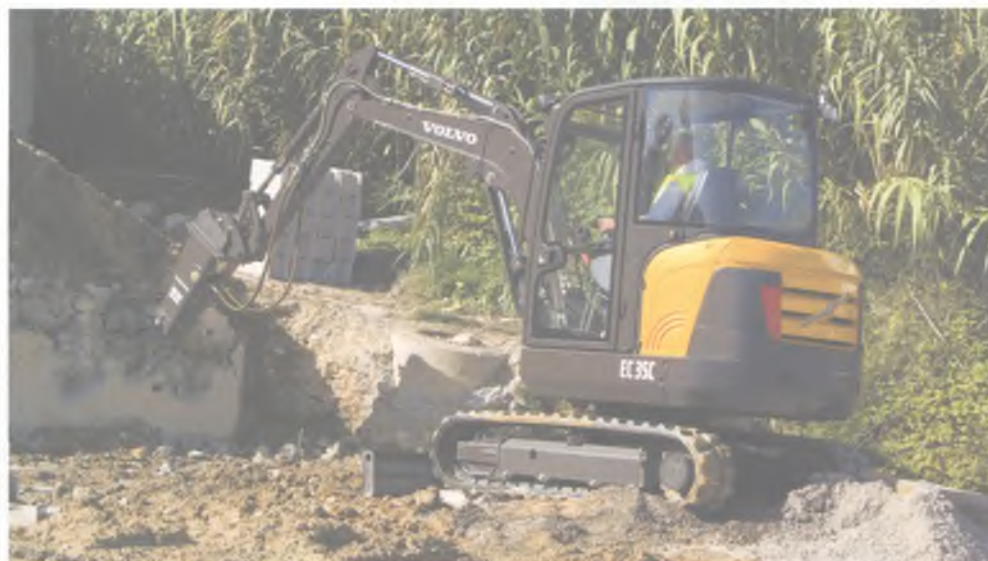
Volvo EC35C , как и практически все мини-экскаваторы, умеет работать с гидромолотом
