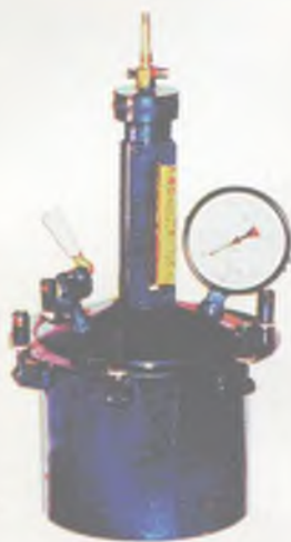
Прибор КП 133А для определения количества попавшего воздуха в бетон (исодузомер)
