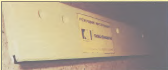
— NGT — нож с твердосплавным износостойким лезвием
