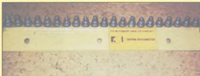
— NGR — нож многократного использования с быстрозъемными резцами, оснащенными твердосплавными наконечниками
