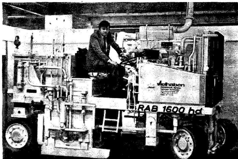
Самоходная дорожная фреза для холодного фрезерования покрытий (фирма «Фильхабен», ФРГ)
