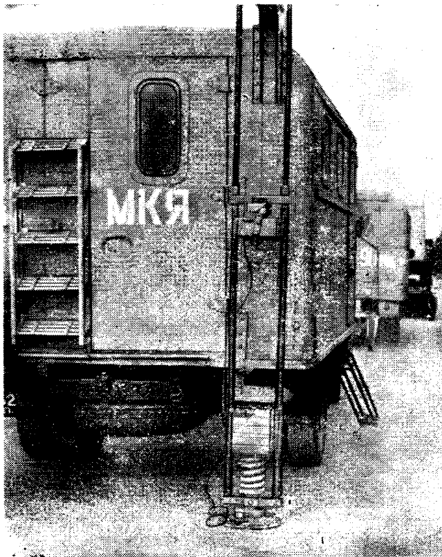
Рис. 2. Установка динамического нагружения УДН-Н
