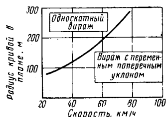
Рис. 3. Область применимости виража с переменным поперечным уклоном
