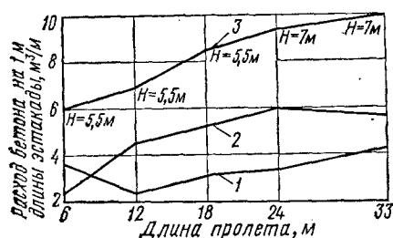
Рис. 1. Объем бетона опор — 1, пролетных строений — 2 и суммарный — 3 на 1 м длины эстакады
