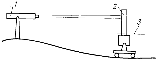
Рис. 1. Съемка профиля местности с помощью автоматического нивелира: 1 — оптический квантовый генератор (лазер); 2 — многоэлементное отсчетное устройство; 3 — плоскость нулевого отсчета
