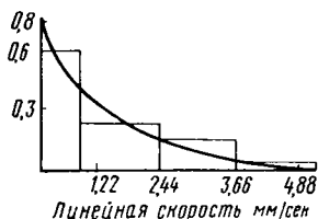
Рис. 2. Изменение линейной скорости перемещения трущихся пар механизма
