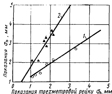
Рис. 4. Корреляционная зависимость между данными измерений неровности покрытия трехметровой и передвижными рейками: 1 — многоопорной рейкой; 2 — двухопорной рейкой
