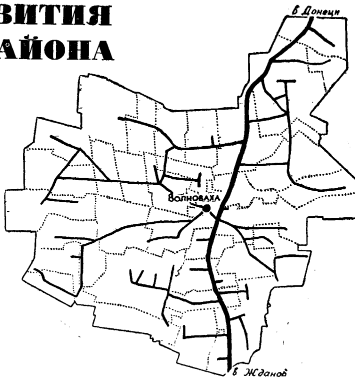
Схема сети дорог с твердым покрытием в Волновихском районе (пунктиром отмечены границы колхозов и совхозов)
