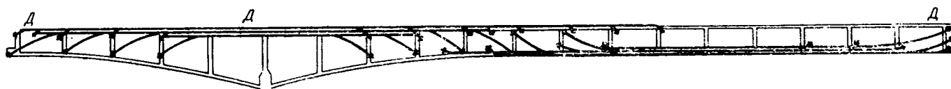
Рис. 3. Схема расположения пучков предварительно напряженной арматуры (Д — места установки диафрагм)
