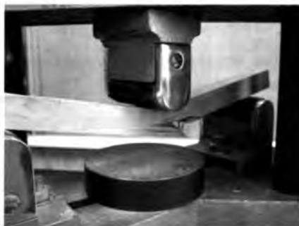
Рис. 5. Испытание на предел прочности древесины берёзы, обработанной при температуре 185°С, при статическом изгибе
