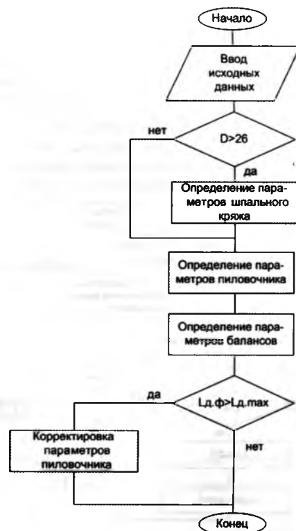
Рис. 2. Схема алгоритма решения комплексной задачи по определению величин параметров разнотипных сортиментов, получаемых при раскряжёвке хлыста
