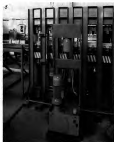
Рис. 3. Общий вид пресса для получения клеёного бруса: а – вид сзади; б – вид сбоку
