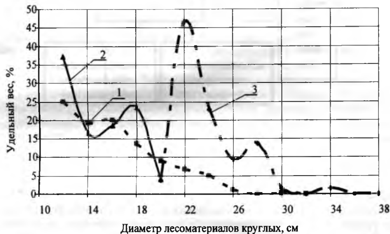
Рис. 5. Графики распределения круглых лесоматериалов по величинам диаметра – для разных схем раскря хлыстов:
