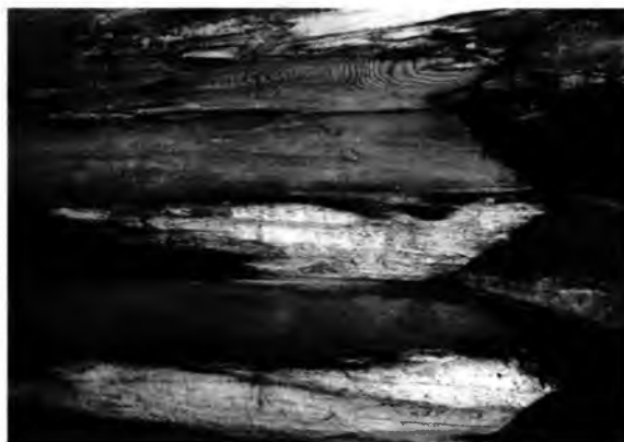
Рис. 6. Древесина, поражённая комплексом микромицетов, вызывающих умеренную гниль (восьмерик Покровской церкви Кижского погоста, 1764 г.)
