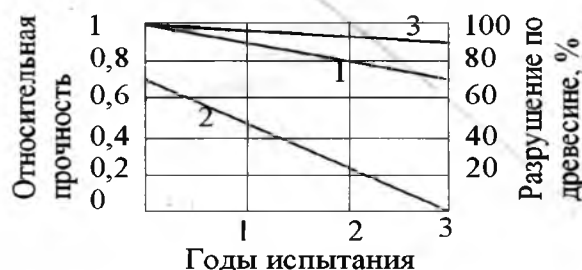
Рис. 2. Графики зависимости относительного показателя прочности КДК на карбамидоформальдегидном клее холодного отверждения от продолжительности срока их службы:
