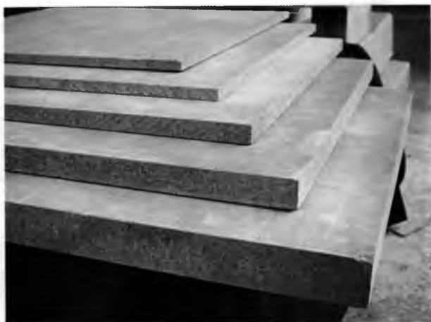
Рис. 2. Образцы ЦСП разной толщины (10, 12, 16, 24, 36 мм)
