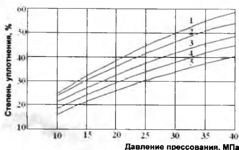
Рис. 2. Графики регрессионной зависимости степени уплотнения строганого шпона сосны от давления прессования ( \tau = 0 ) – при различных величинах температуры плит пресса:
