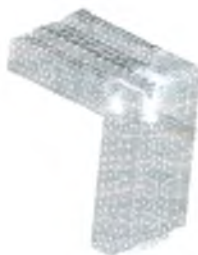
Рис. 2. Результат генерирования объёмной конечно-элементной сетки углового соединения
