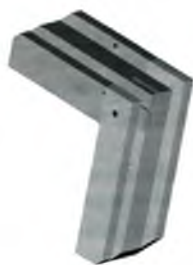
Рис. 1. Твёрдотельная модель углового соединения створки оконного блока
