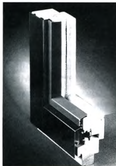
Рис. 13. Профильная алюминиевая оболочка, насаживаемая на деревянное окно для защиты древесины
