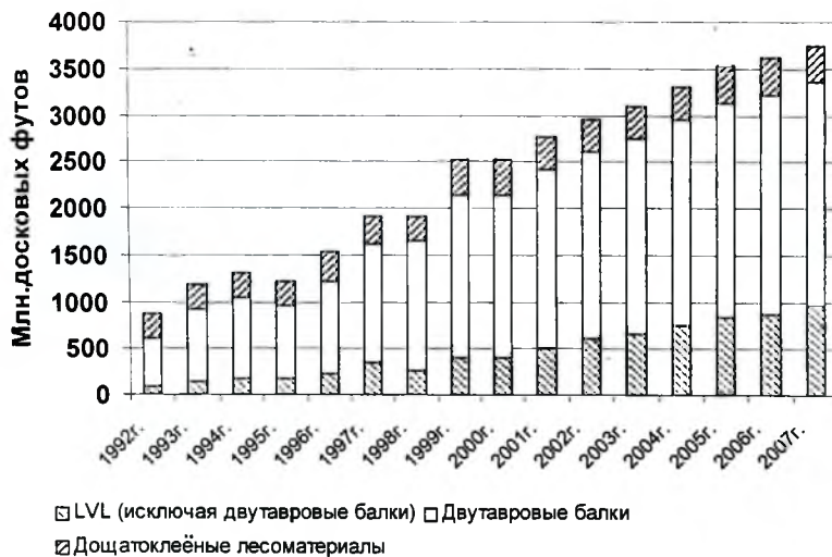
Рис. 1. Годовой объём производства и потребления конструктивных материалов из древесины в Северной Америке:
