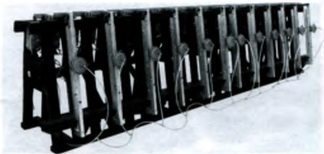
Рис. 9. Модульный пневматический пресс “Эльбрус” для склеивания дверного и оконного блока, строительного бруса и мебельных щитов
