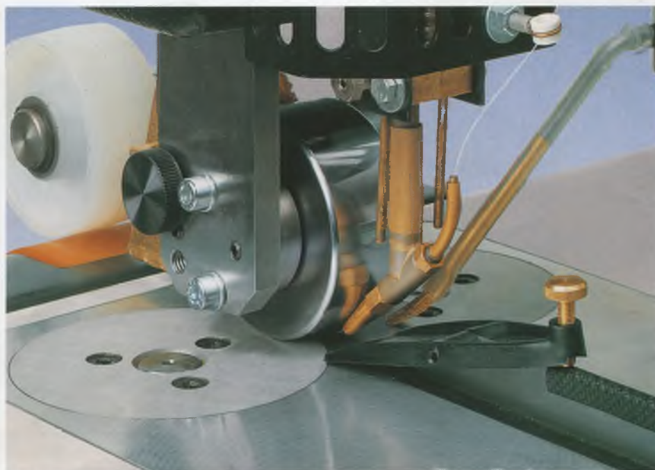
Рис. 20. Узел ребросклеивающего станка фирмы “Купер” для сращивания шпона клеевой нитью методом “зиг-заг”
