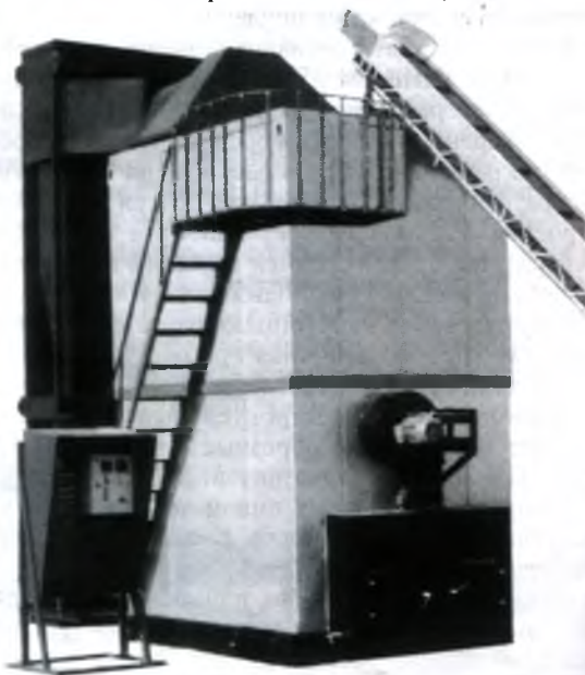
Рис. 7. Топка Померанцева тепловой мощностью
