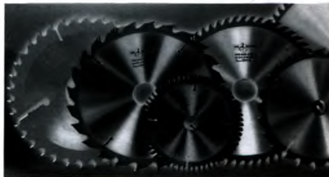
Рис. 12. Круглые плоские пилы с пластинками из твёрдого сплава
