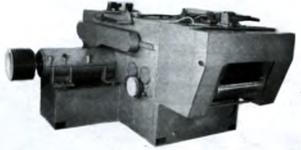
Рис. 4. Восьмипильный станок Ц8Д-8М для продольной распиловки брусьев
