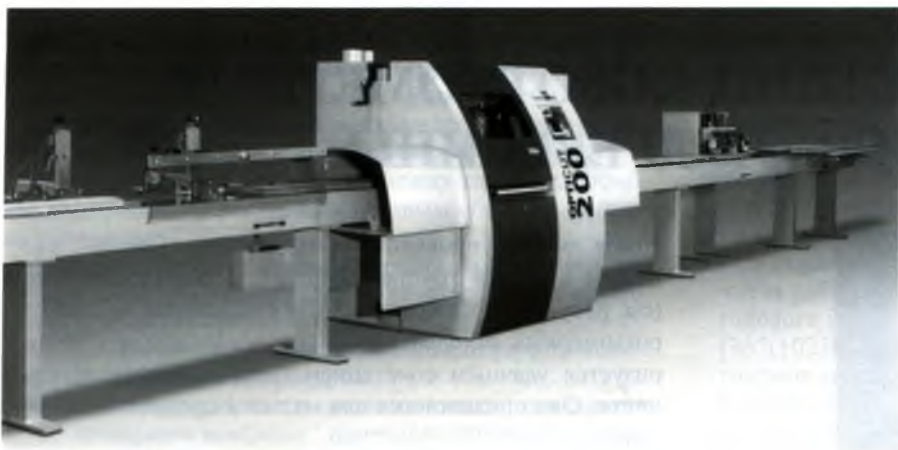
Круглопильный станок OptiCut 200 Elite с системой оптимизации поперечного раскроя пиломатериала
