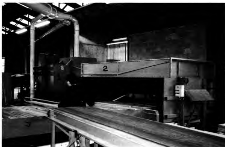
Ограждение позадистаночной зоны многопильного станка с "плавающими" пилами (Франция):
